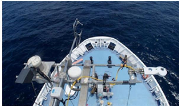
*Vue des instruments de mesure rapide du mat flux, © H. Barrois*
