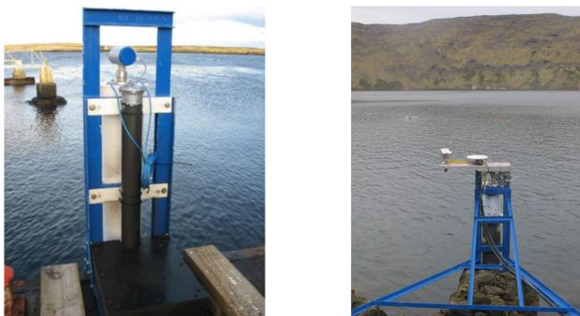
Figure 2. Sites marégraphiques côtiers de Kerguelen (gauche) et Saint-Paul (droite) comportant un tube de tranquillisation avec marégraphe à pression et radar. Une station GNSS permanente est installée au-dessus du marégraphe de Saint-Paul.
