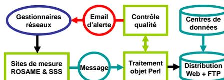
Figure 4. Schéma de fonctionnement du traitement automatisé et mutualisé entre les réseaux d'observations.
